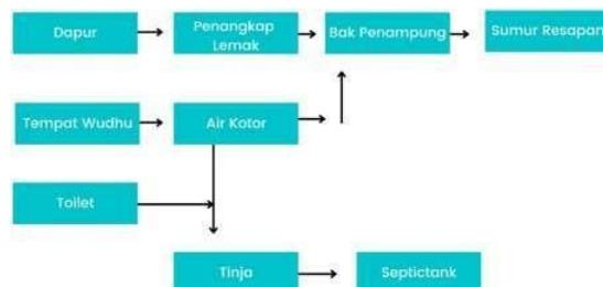
Gambar 13. Sistem Limbah Pembuangan
